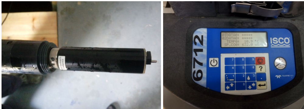
Figura 6. Sensor YSI® 6136 (Izquierda) conectado a un tomamuestras automático ISCO 6712 (Derecha)
