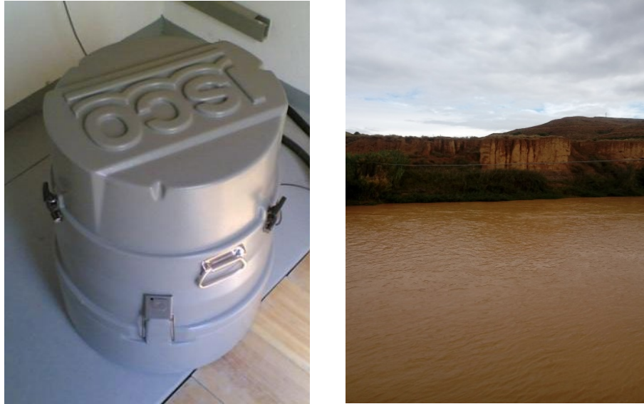
Figura 8. Muestreados automático ISCO 3700 en la estación del Cinca en Fraga (Izquierda). Río Cinca durante una crecida el 15-10-18 (Derecha).
