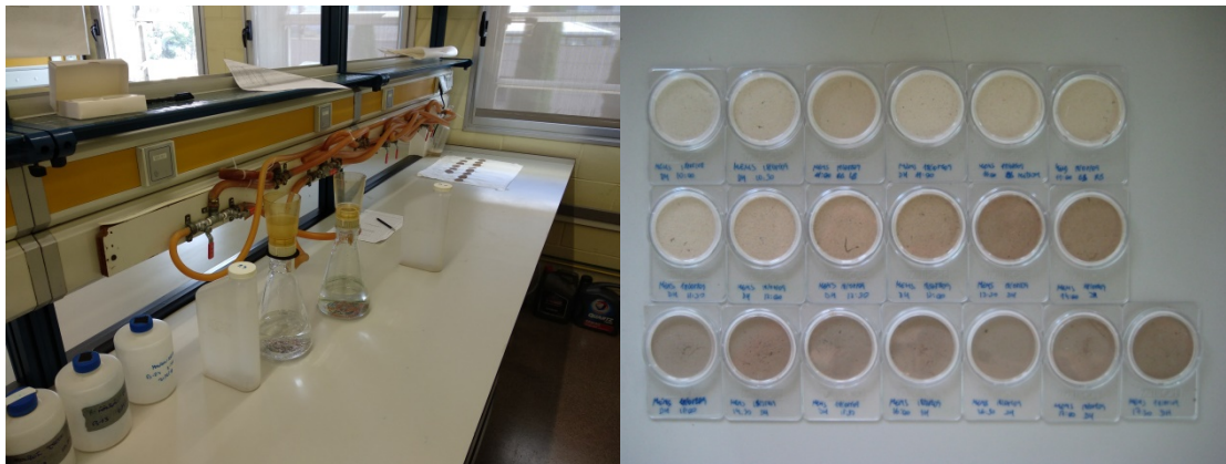
Figura 5. (izquierda) Equipo de filtrado y, (Derecha) ejemplo de filtros después del proceso de filtrado.
