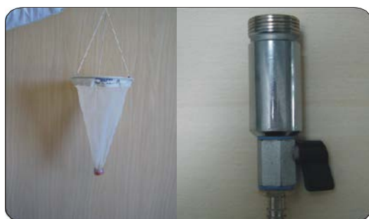
Figura 2. Arriba. Utensilios de muestreo: Izquierda, red de plancton de 50 \mu\text{m} , derecha, receptor del material filtrado.
