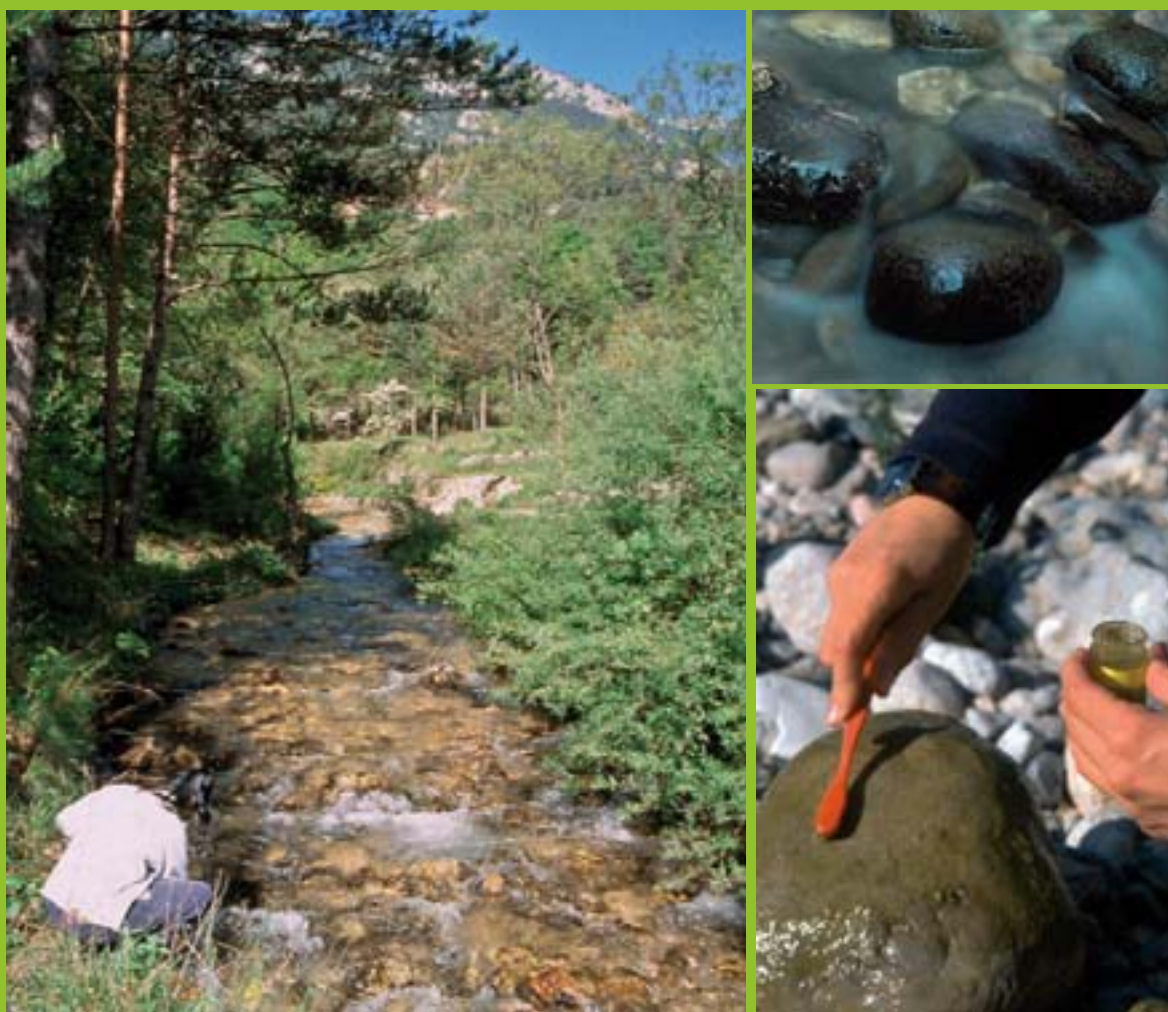
Seleccionar un tramo bien iluminado y en zona de corriente. Escoger piedras y cantos rodados sumergidos. Cepillar la superficie del sustrato; limpiar el cepillo en el recipiente con agua.
