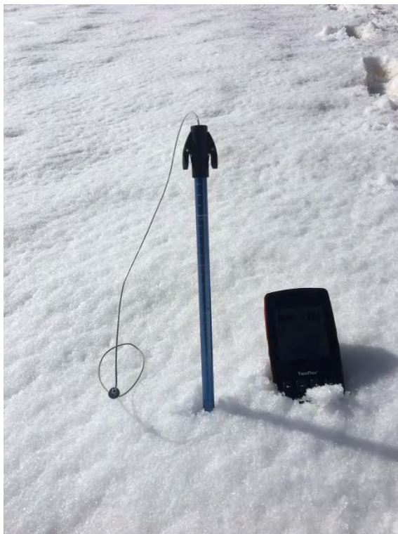
Cota 3.000 m. 282 cm de espesor medio
