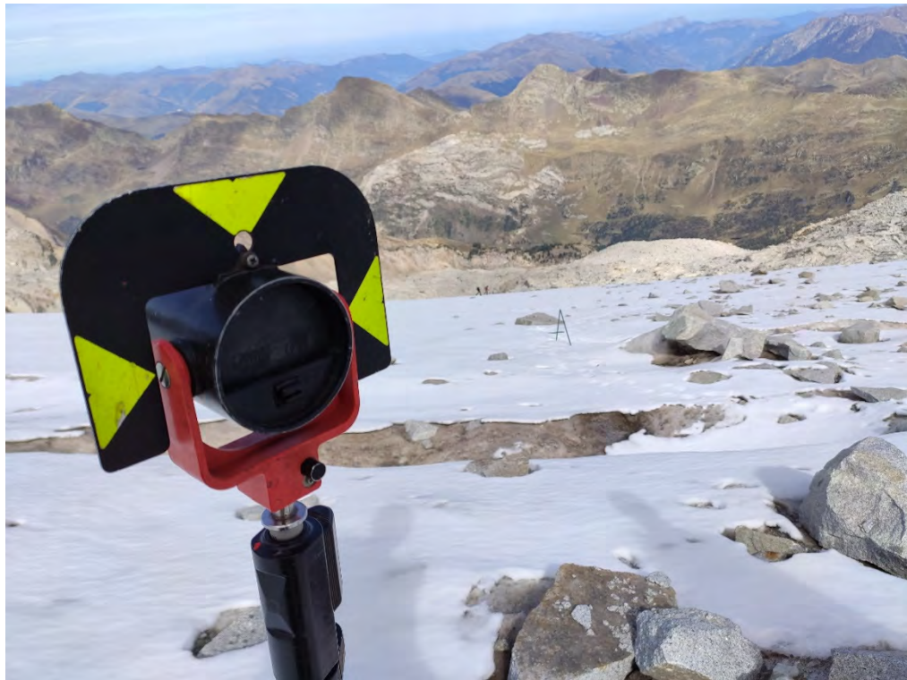
Tomando puntos por la parte alta del glaciar. Prisma, baliza 28 y segundo equipo más abajo
