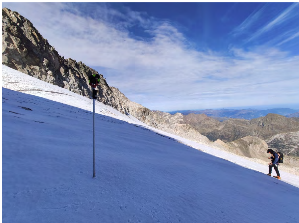
Medición de puntos de la superficie del hielo glaciar (bajo unos 10 cm de nieve nueva. Jalón en contacto con el hielo) junto a la baliza 27
