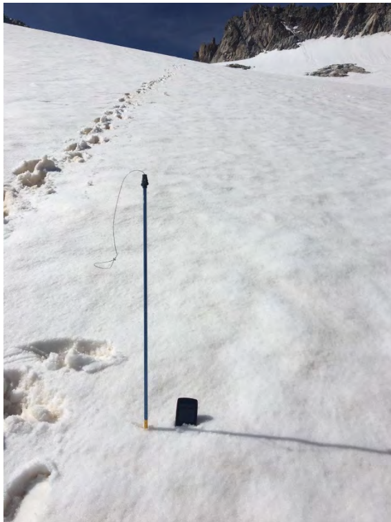
Cota 2.940 m. 253 cm de espesor medio
