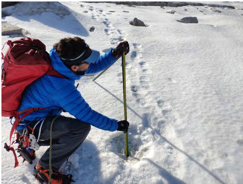
Baliza 28, cota 3.114 m. Pérdida de 207 cm de espesor de hielo. Desplazamiento horizontal de 2,84 m
