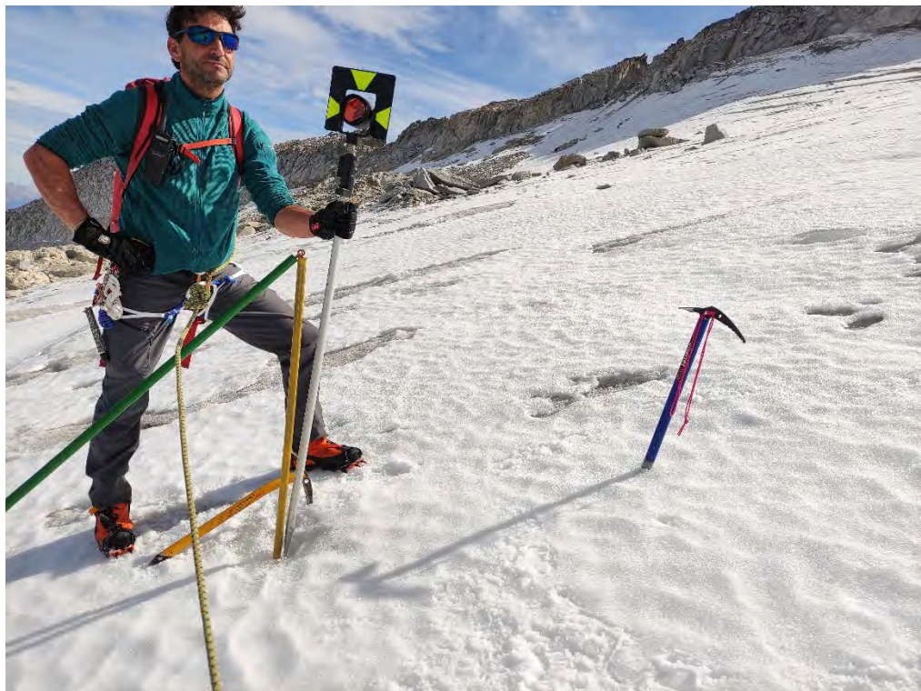
Baliza 29, cota 3.057 m. Pérdida de 273 cm de espesor de hielo. Desplazamiento horizontal de 2,85 m
