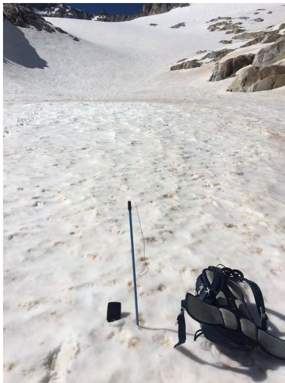
Medida del espesor a cota 2.870 m. 283 cm de espesor medio.
