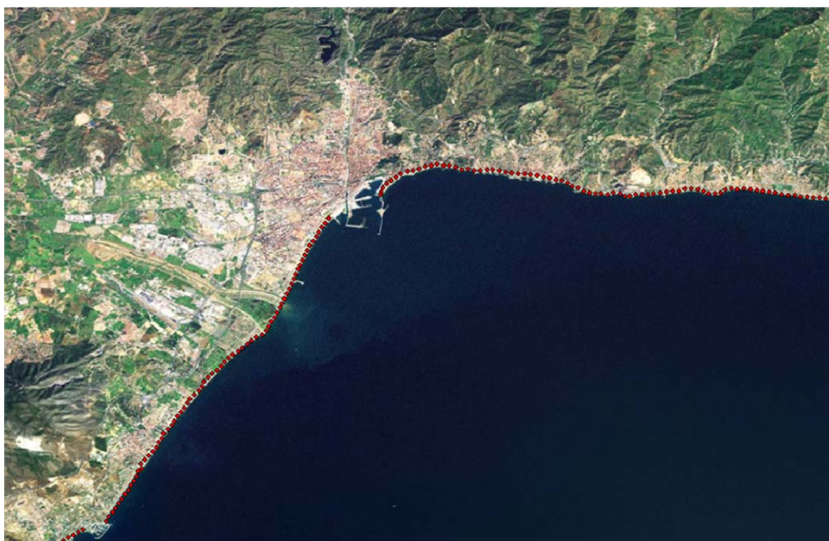
Figure 4. Ejemplo de la segmentación realizada en la línea de costa. Puntos rojos cada 200 m.
