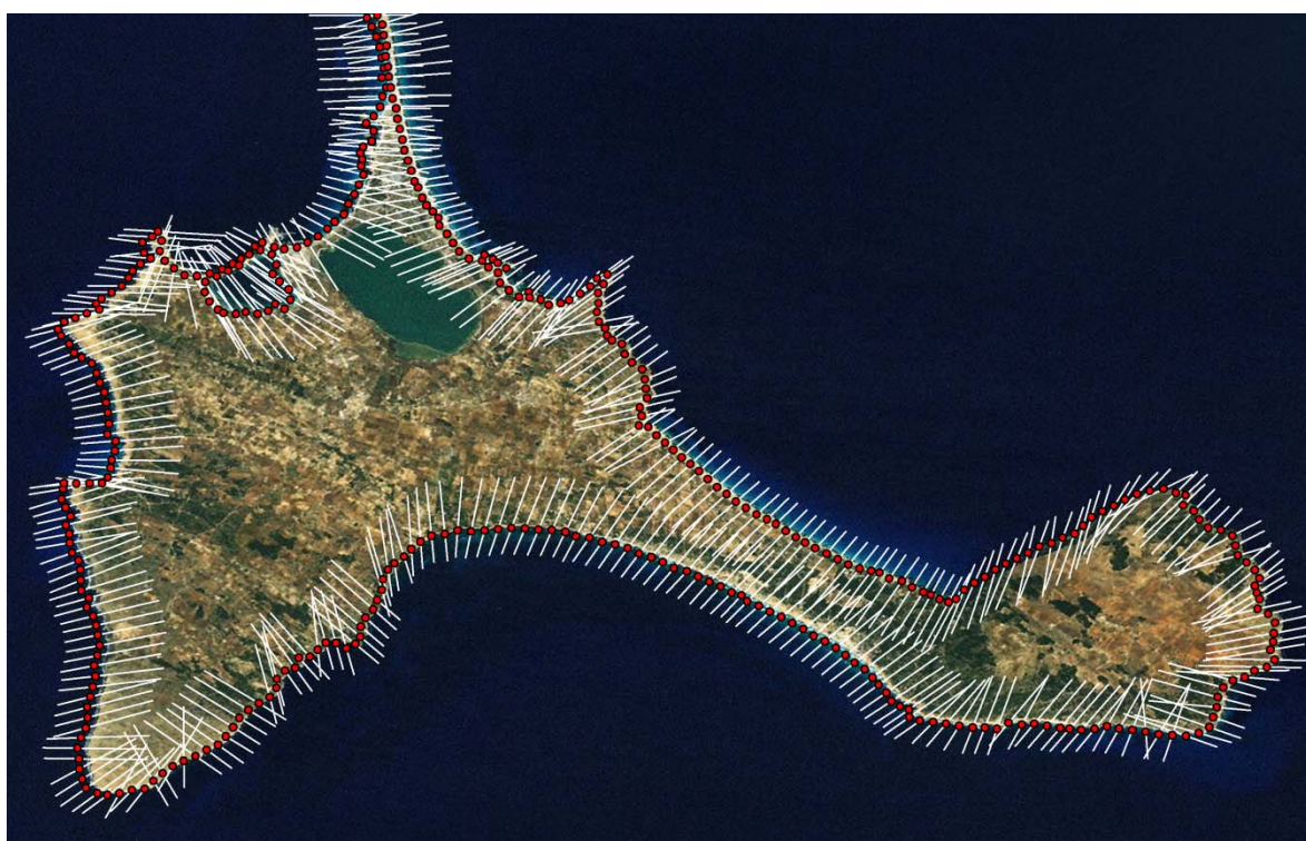
Figure 7. Ejemplo de la segmentación realizada en la isla de Formentera. En rojo, los puntos de la línea de costa cada 200 m. En blanco, perfiles del terreno según la dirección del flujo medio de energía de los temporales.
