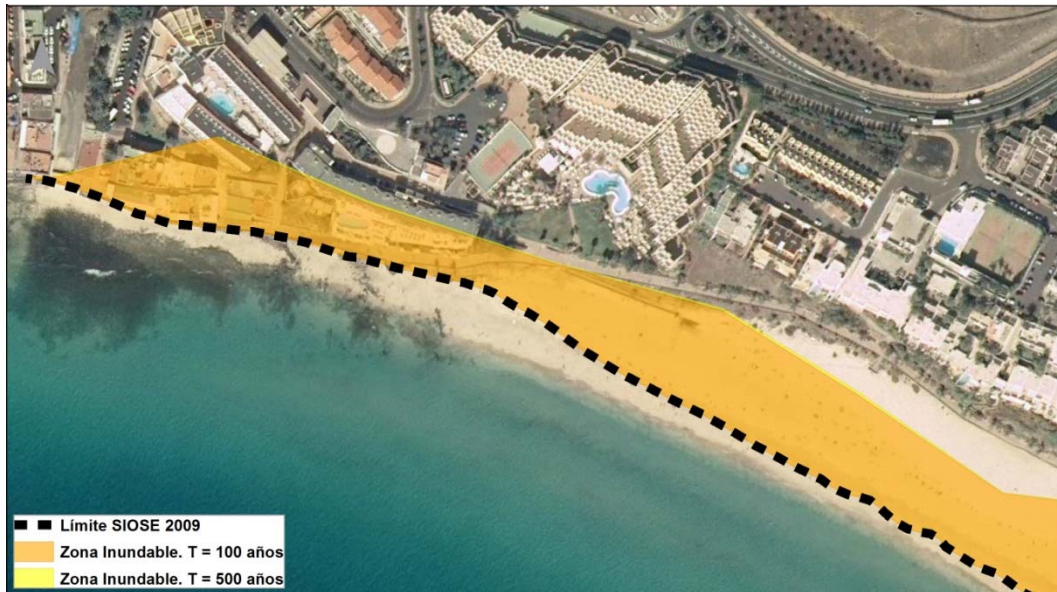
Figure 27. Ejemplo en el que el límite del SIOSE 2009 no alcanza a cubrir toda la zona de playa seca mostrada por la ortofoto (PNOA 2006)
