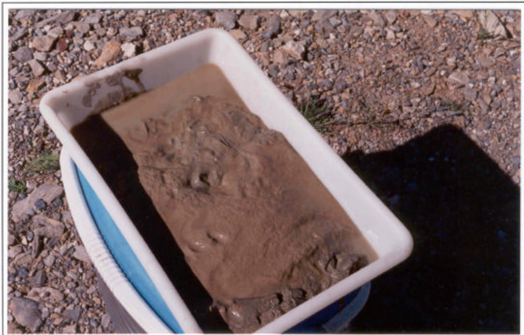
Sedimento extraído del fondo del embalse, en la zona de la presa.
